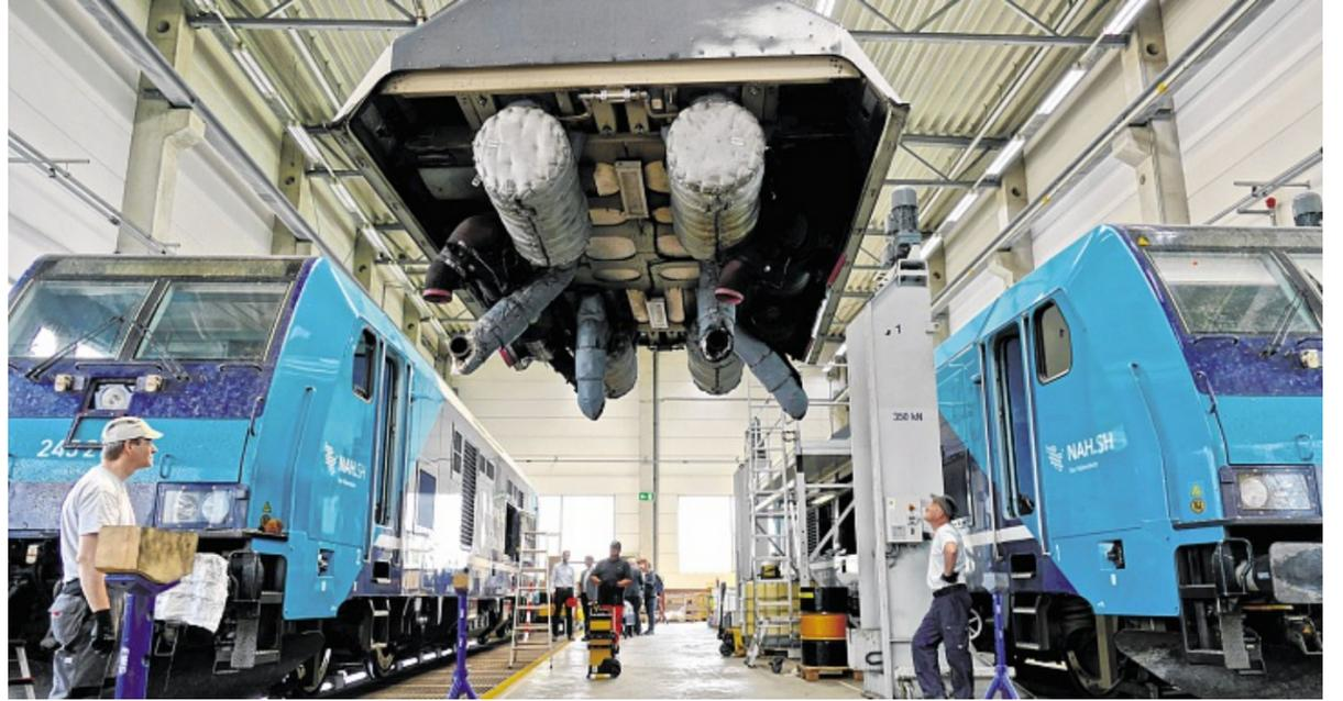
Langsam wird das Dach der zwölften Lok in Richtung Boden befördert.
